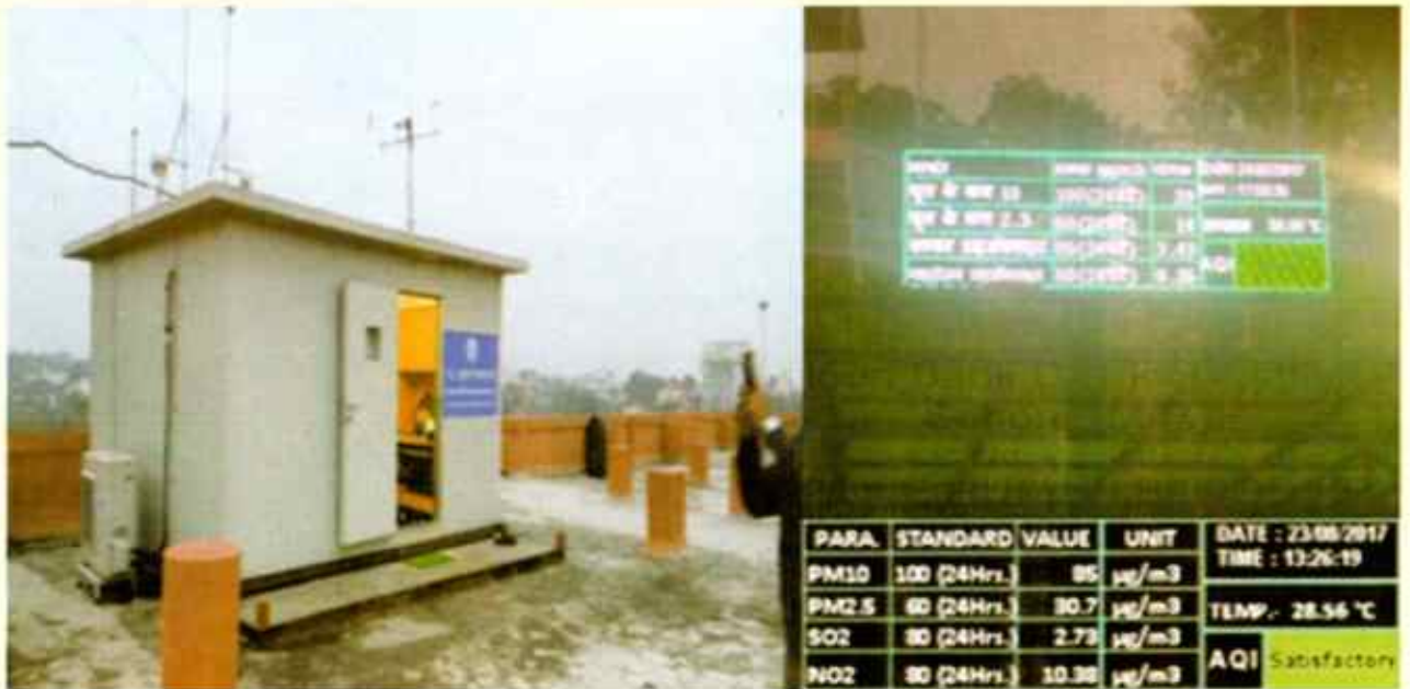
उज्जैन शहर में स्थापित रियल टाइम कन्टीन्युअस ऑनलाइन एयर क्वालिटी मॉनिटरिंग स्टेशन
